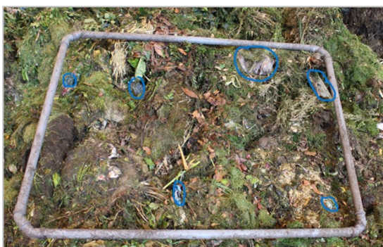
Abb. 2: Bestimmung der Anzahl an Fremdstoffen auf einer definierten Fläche von 2,5 m²
