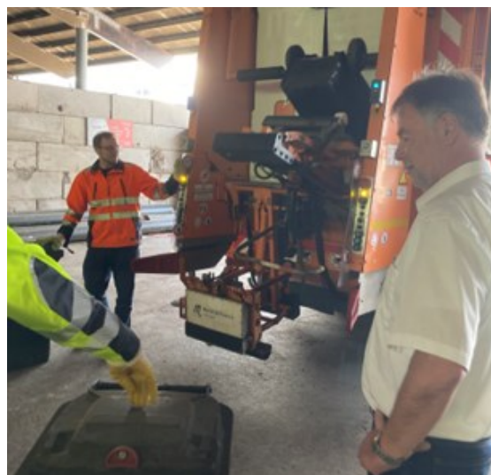
Abbildung 3: Die präparierten Tonnen wurden im Anschluss an die optische Sichtung durch die Teilnehmenden mit einem Metalldetektionssystem auf Fremdstoffe untersucht.
